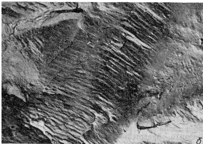
Рис. 85. Микрорельеф в зоне стабильного развития трещины стали 07X13H4AG20; испытание на усталость при 293 К (а) и 77 К (б); \times 8000
